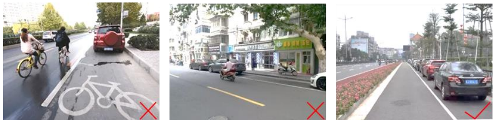
图22 路内停车泊位设置示意图
