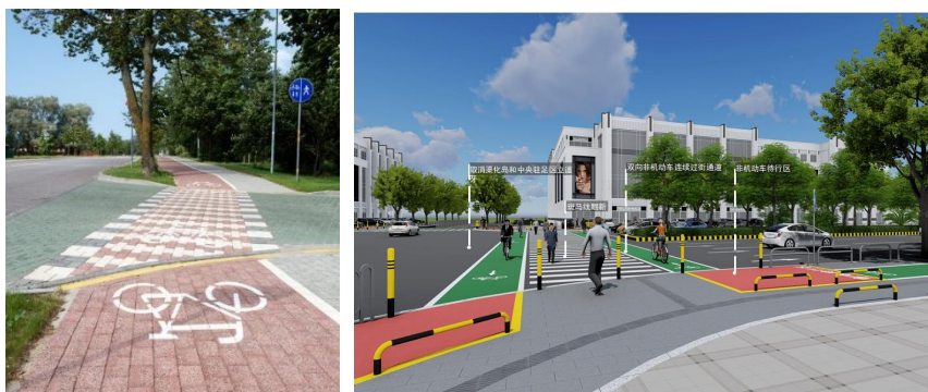
图14 非机动车道无障碍设计示意图
